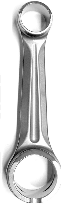
Photo de la bielle gauche / Photo of the conrod left
